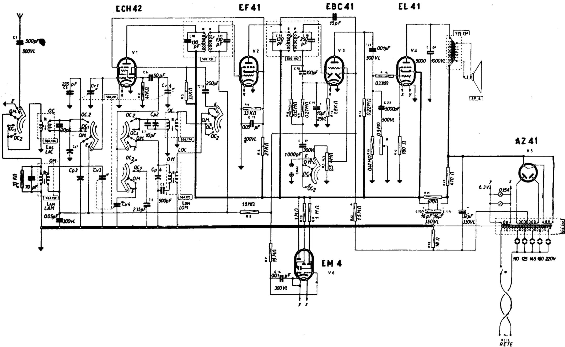
VOCE DEL PADRONE - Mod. 515. Una gamma onde medie e due gamme onde corte spostate. Media frequenza 465 kc/s. Potenza d'uscita 3 watt. Consumo 40 watt.
